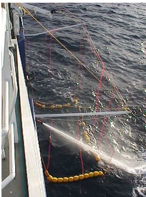
Figura 3: Aparato para excluir a las aves utilizado por el BP Janas .
