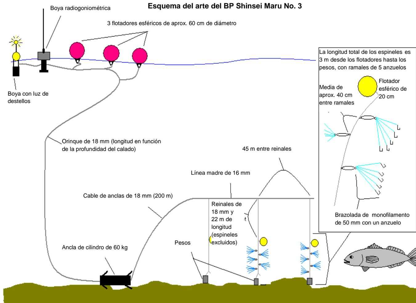
Figura 5: Diagrama de la configuración del palangre artesanal desplegado en lances de investigación realizados por el *Shinsei Maru No. 3* en 2011 en las Divisiones 58.4.3b, 58.4.4a y 58.4.4b. En WG-FSA-11 se recomendó modificar esta configuración del palangre para los lances de investigación efectuados en las mismas áreas en 2012.
