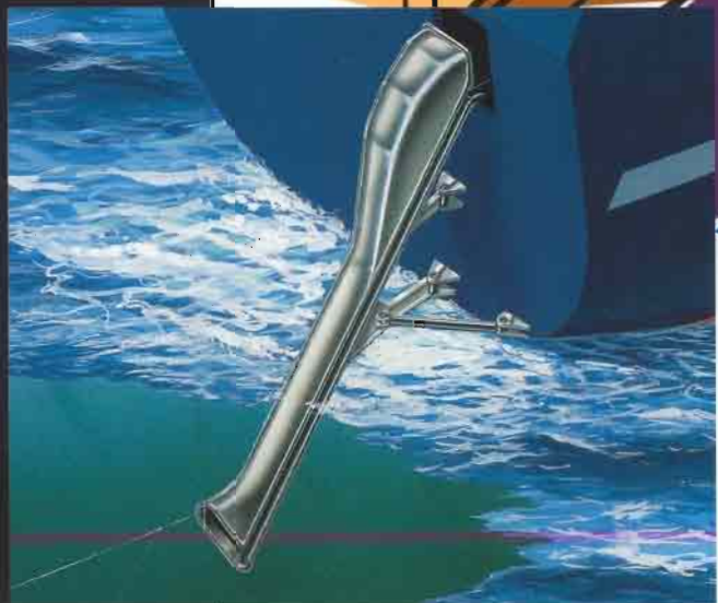
Toboggan conçu par "O. Mustad & Son A.S." pour poser la palangre sous l'eau à l'arrière du navire
