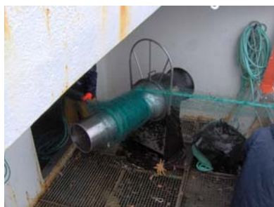
Рис. 1: Барабан или вал для выборки жаберной сети.
